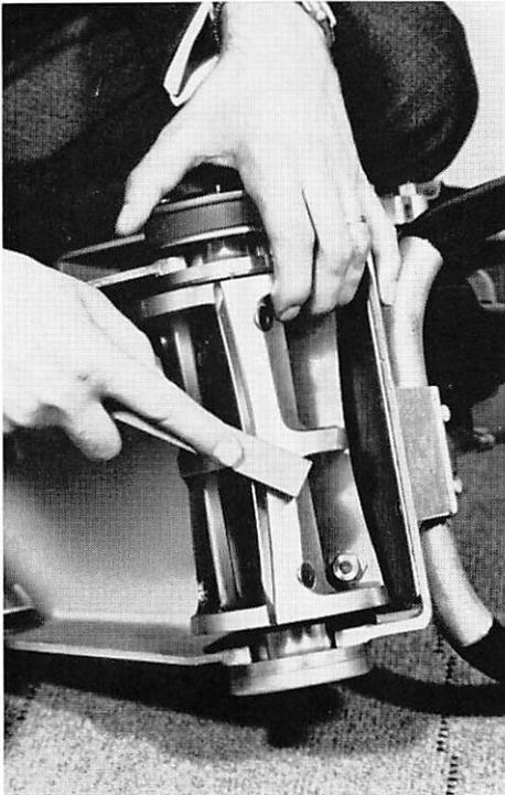
Sie können die Messer zum Abziehen auch ausbauen und z. B. in einen Schraubstock einspannen. Diese Methode hat den Vorteil, dass Sie den Abziehstein mit beiden Händen anfassen können und dadurch kräftiger abziehen können.
