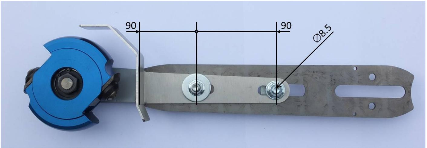
Am bestehendem Schwert werden 2 Löcher  $\varnothing$  8.5 mm gebohrt. Daran wird der Log Master mit 2 Schrauben M8x30 und dazugehörigen Muttern verschraubt.
